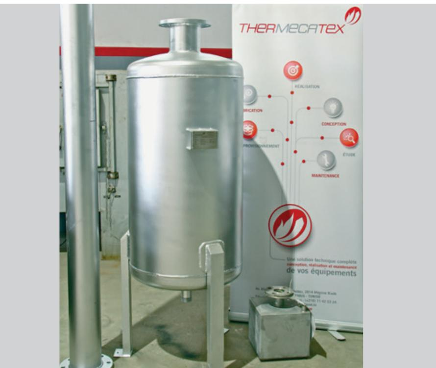
Le barillet d'éclatement des purges est un réservoir qui reçoit les purges du réseau de vapeur pour éviter les risques liés aux jets de vapeur (mélangés avec de l'eau) à haute pression, haute température et à grande vitesse (vapeur flash)
